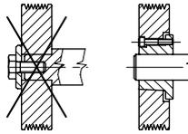
2) Qualora vi siano movimenti di rotazione soggetti a brusche e frequenti inversioni di moto, la bussola conica evita, per effetto del bloccaggio che genera sull'albero, lo schiavettamento e la tranciatura della chiavetta di trascinamento.
