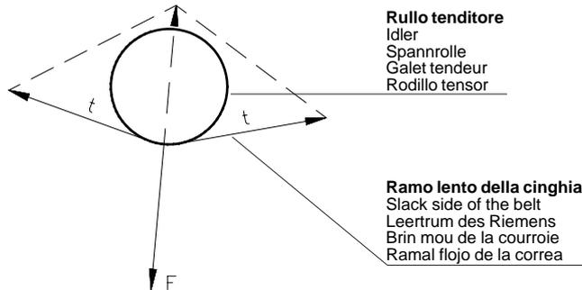
Se si utilizza il rullo tenditore si dovrà collocarlo sul tratto lento della cinghia, lo sforzo che si dovrà applicare sarà tale da compensare l'effetto della tensione  $t$  del tratto della cinghia. Se si applica la tensione sull'albero di una delle pulegge questa tensione dovrà compensare la risultante  $R_o$  delle tensioni di ciascun tratto.
